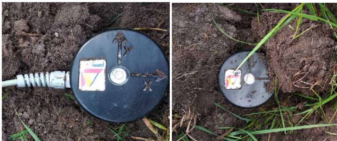
Figuren 4 en 5: foto's van de ondergrondse posities van de geofons.
